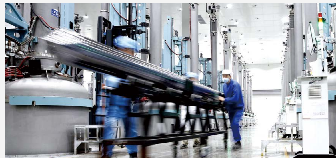
徐州光伏颗粒硅技术应用示范项目现场，员工们运送一根 6 米多长的单晶硅棒
