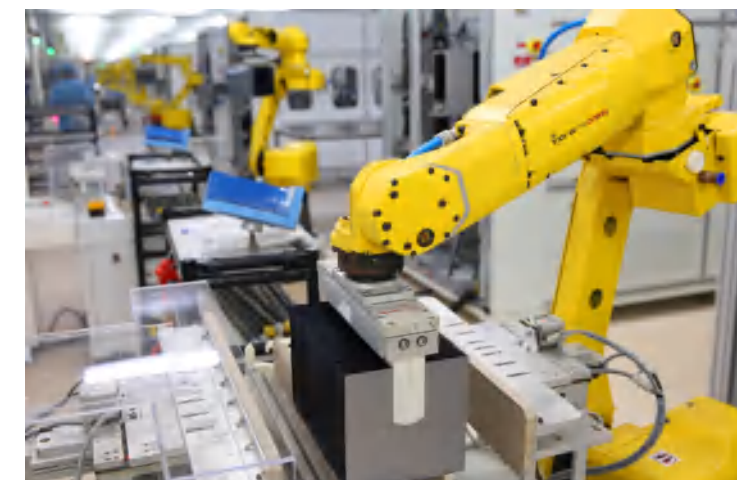
扬州协鑫光伏科技有限公司 黑硅车间机器人自动上下料流水线
